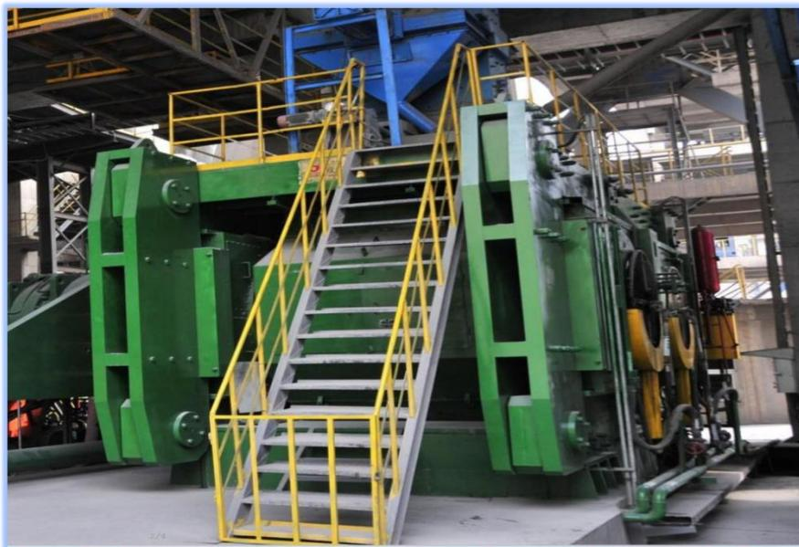
立磨改辊压机技术改造
